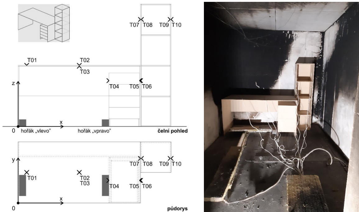
Obr. 19: Schéma nábytkové sestavy včetně rozmístění termočlánků. Fotka sestavy z překližky v rohu místnosti.
